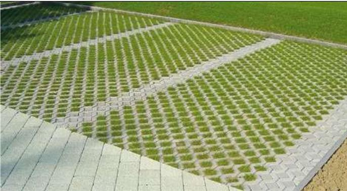
Les stationnements et passages perméables seront réalisés en pavés à joints creux (image non contractuelle).
